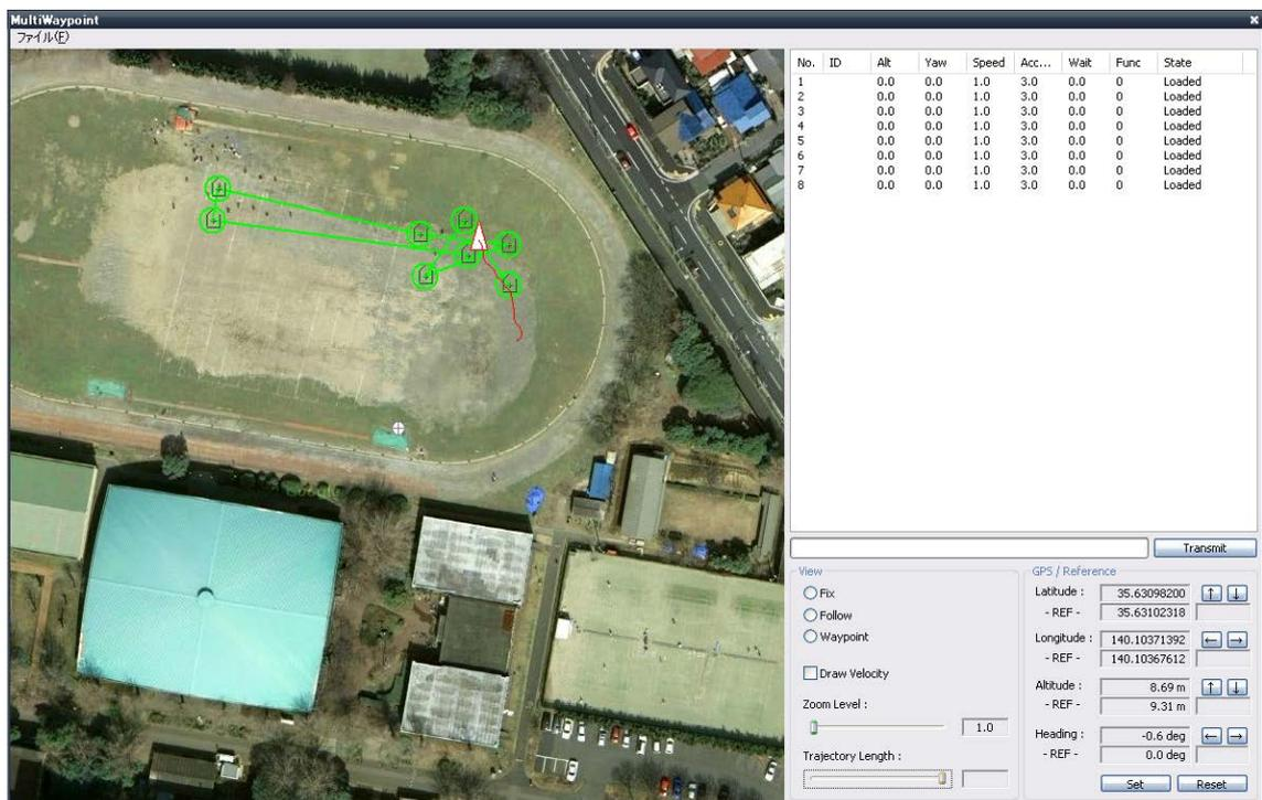
図10 ウェイポイント飛行専用ウィンドウ
