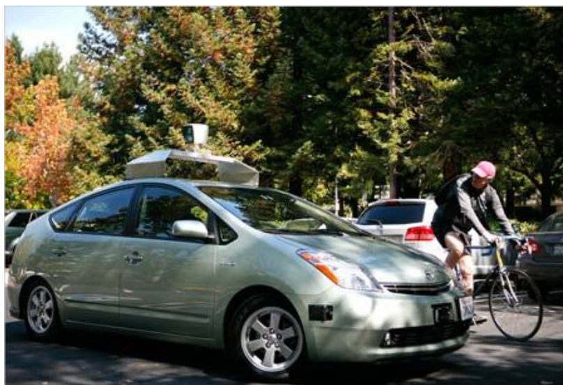
図2:グーグルが開発中の自動運転車 トヨタの「Prius」がベースの車両。米国ネバダ州やカリフォルニア州の公道で実験中 だ。
