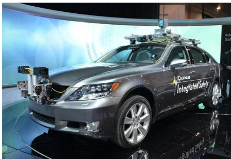
図1:トヨタが開発中の自動運転車 Lexusブランドのハイブリッド車「LS600hL」がベース。レーダやカメラなどのセンサが むき出しで、実験車と一目で分かる外観である。
