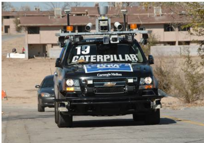
図4: Urban Challengeが開発競争のきっかけ 米国防総省の研究機関(DARPA)が主催。市街地を模擬したコースで無人の車両を走らせた。写真は優勝したカーネギーメロン大学とGMなどが共同で開発した車両。人が乗らないので、フロントガラスに字が大きく書いてある。
