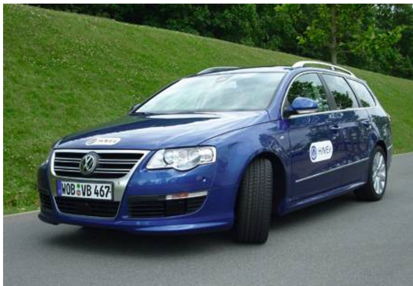
図7: VW社の高速道路に限定した自動運転車 EUのプロジェクトで開発。ほとんど既存のセンサで実現する。
