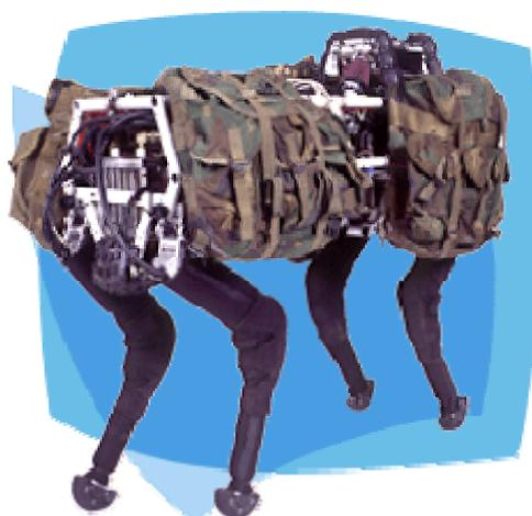
図5 BigDogのロボットラバ<sup>11</sup>
