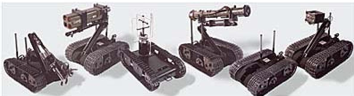
図 3 武装版タロンロボット ( <http://www.foster-miller.com/lemming.htm> より )
